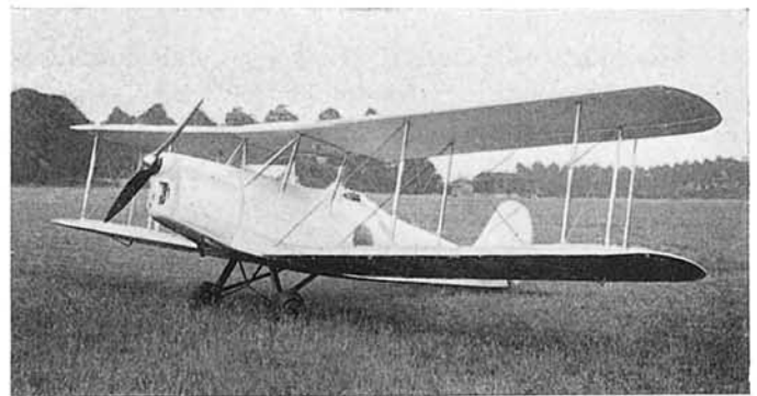
Fig. 4. — Avión Stampe y Vertongen III, motor D. H. Gipsy III invertido, con el clásico capotaje de este motor.
