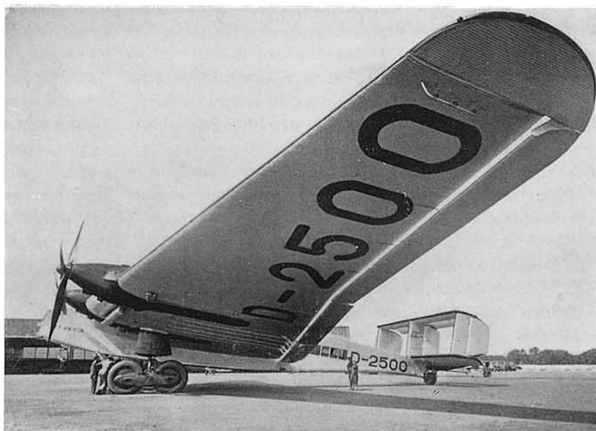
El cuatrimotor comercial alemán Junkers G. 38-2500, de 23 toneladas de peso total y 3.200 cv. de fuerza motriz.
