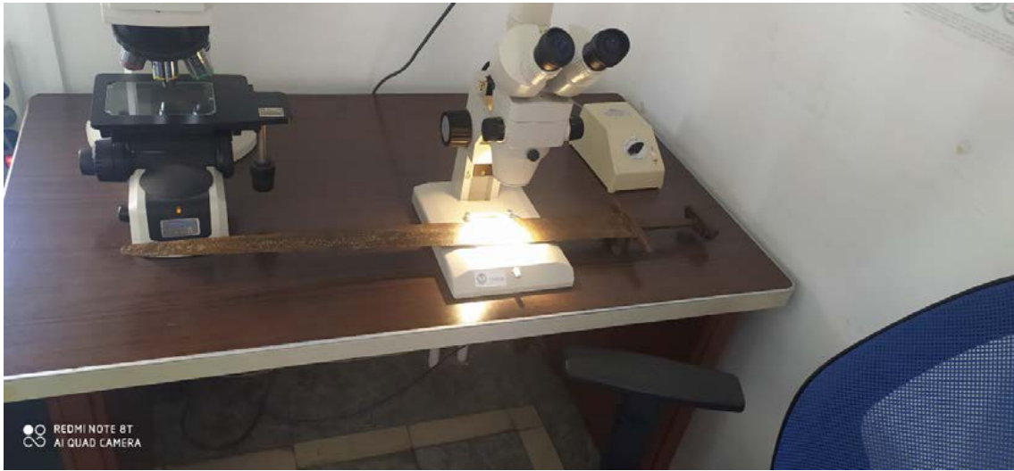
Figura 26. Lupa para metales a la derecha y microscopio para metales a la izquierda. Laboratorio de metalotecnia de la ETSIAN (Fuente: el autor)
