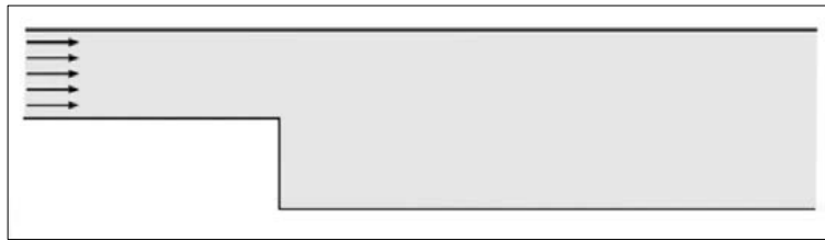
Ilustración 12. Dominio de aplicación del modelo de turbulencia LES
