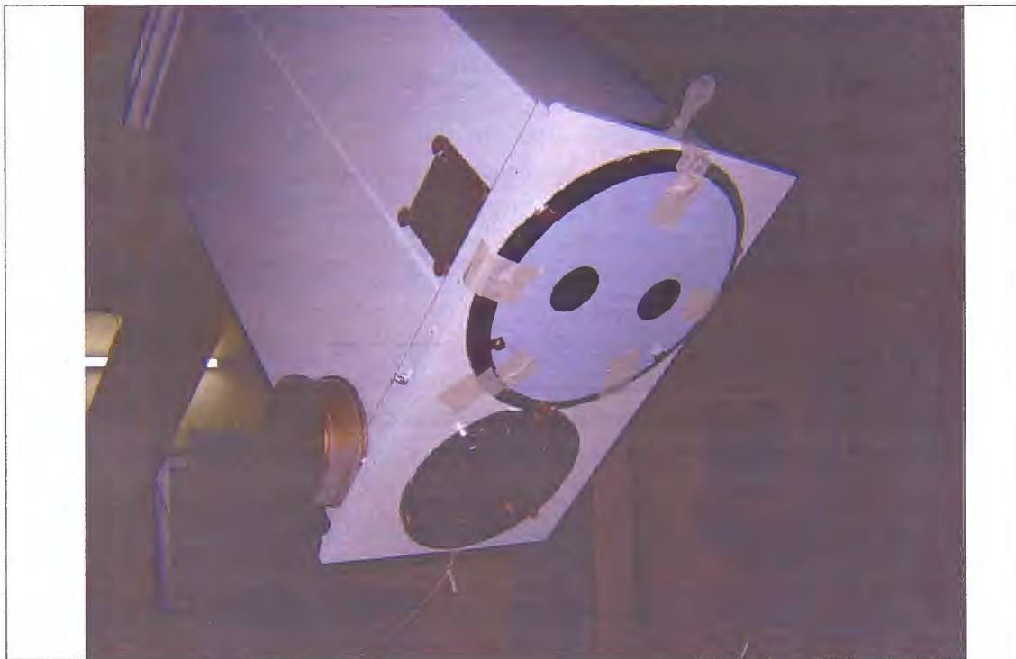
Fig. 12. Objetivo del Astrógrafo del ROA en el cual se le ha adosado una máscara de Hartmann para la búsqueda del plano focal del telescopio una vez adaptada la nueva cámara CCD.
