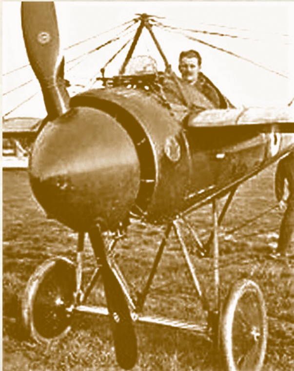
A bordo de un Morane-Saulnier Tipo N, que tenía ya incorporado el dispositivo de disparo a través de la hélice, llamado también Dispositivo Garros
