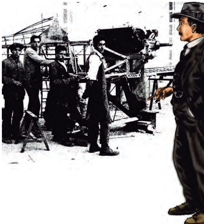
1919. Caza Hispano-Barrón con motor Hispano-Suiza T-35 en el interior de la fábrica La Hispano en Guadalajara, en primer término, el ingeniero proyectista, Eduardo Barrón. Composición y dibujo de Alberto Laguna.
