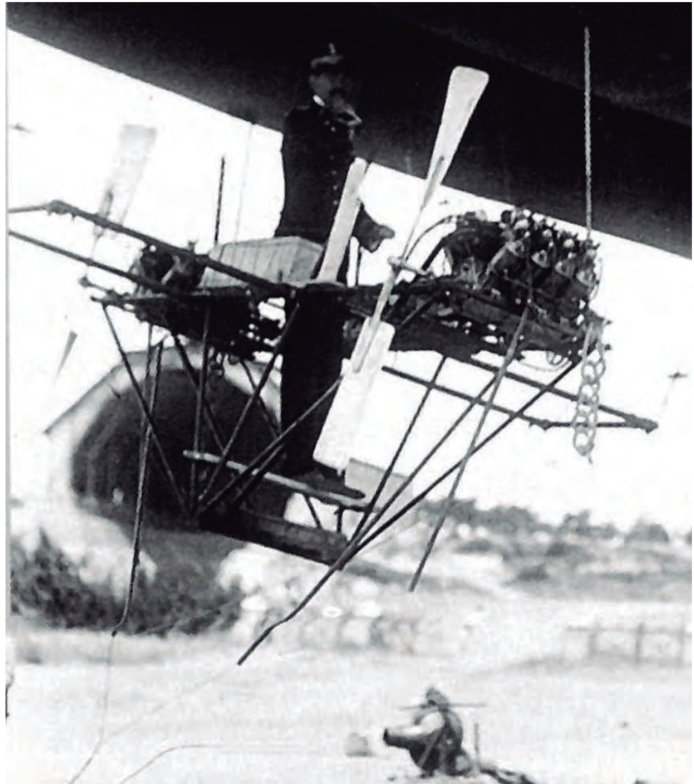
1908. Parque de Aerostación Guadalajara. Motores Antoinette de 24 CV, instalados en el dirigible Torres-Quevedo.
