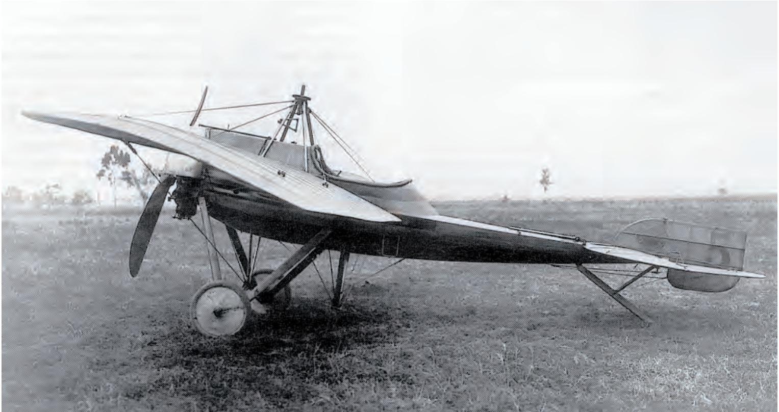
Vista lateral del Monocoque II en la que vemos claramente la ausencia de alerones y la cantidad de cables para torsionar las puntas alares.
