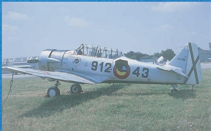
*En esta vista del C.6-149, tomada en Getafe el 28 de mayo de 1977, puede apreciarse que tiene abierta la compuerta de acceso al compartimento del equipaje y de la batería. (J.L. González Serrano).*
