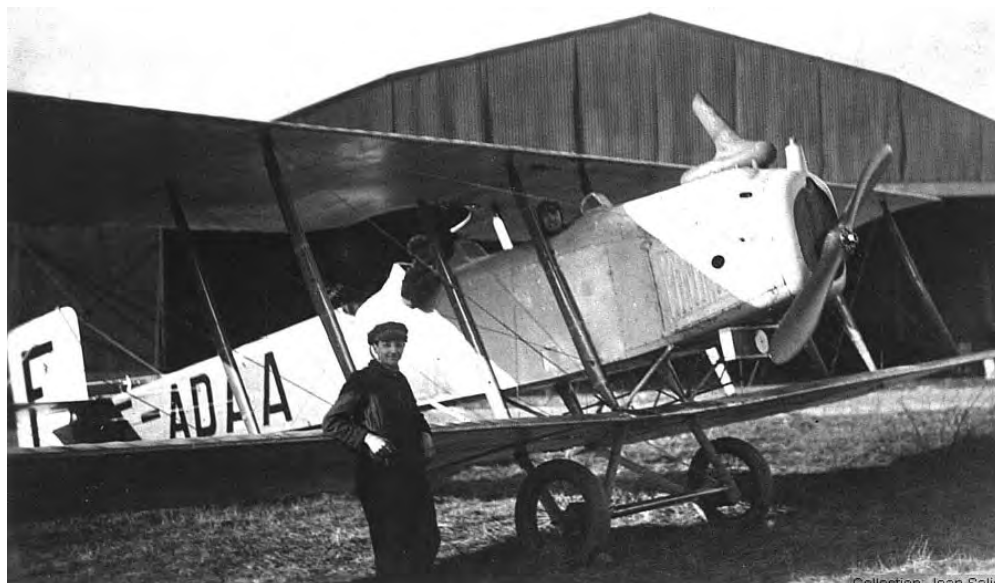
Avión Dorand A.R.2 adaptado como transporte civil, similar a los utilizados por la S.R.A.T. en la línea Argel-Biskra.
