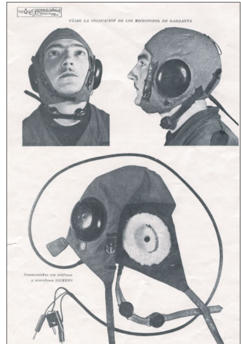
Vistas de los laringófonos Siemens (Foto Fuerzas Aéreas. Colección S. Guillén)
