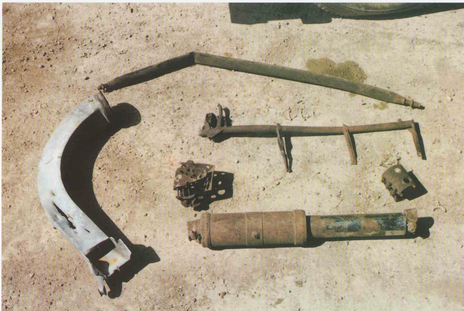
Restos de uno de los "Natacha" caído a 1 km. al S. de Fontllonga, y que se guardan en el vecino caserío de Figuerola de Meià. Se distinguen parte de un amortiguador del tren; un montante interplanos; el esqueleto metálico de uno de los alerones del plano superior, y tolva alimentadora –o recogida de vainas– de la ametralladora, con señales de impactos.
