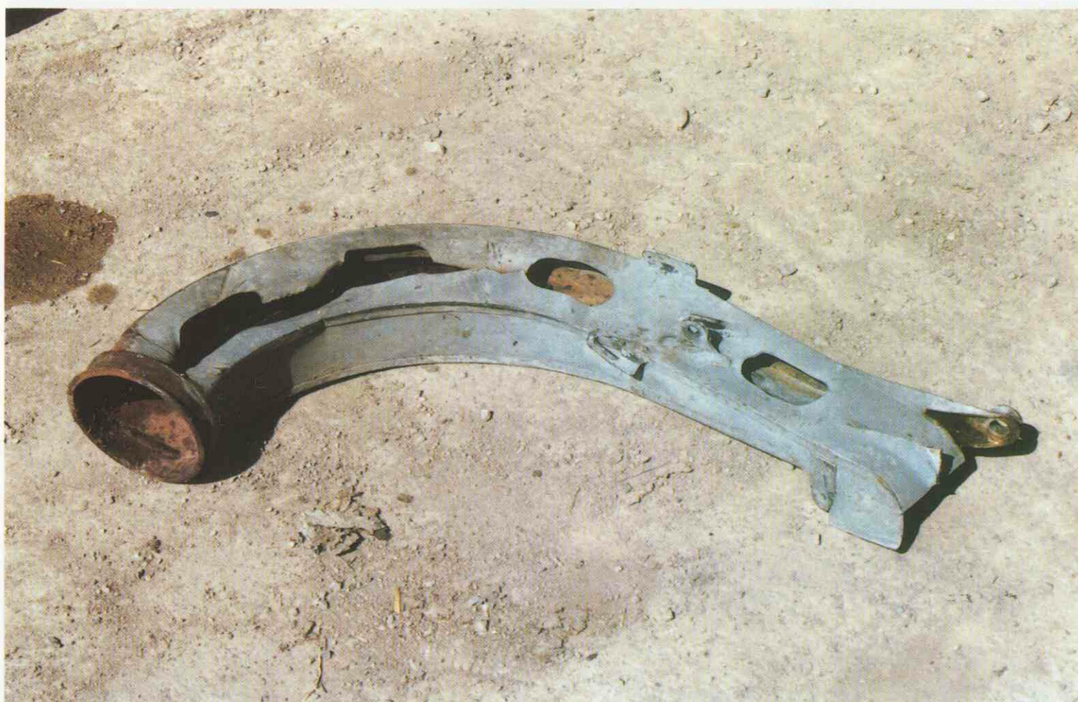
Restos de uno de los "Natacha" caído a 1 km. al S. de Fontllonga, y que se guardan en el vecino caserío de Figuerola de Meià. Se distinguen parte de un amortiguador del tren; un montante interplanos; el esqueleto metálico de uno de los alerones del plano superior, y tolva alimentadora –o recogida de vainas– de la ametralladora, con señales de impactos.
