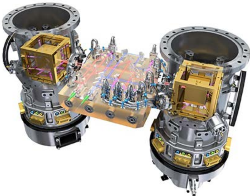
Figura 7. Configuración del experimento tecnológico de la misión LISA Pathfinder. (Créditos: ESA/ATG medialab)
