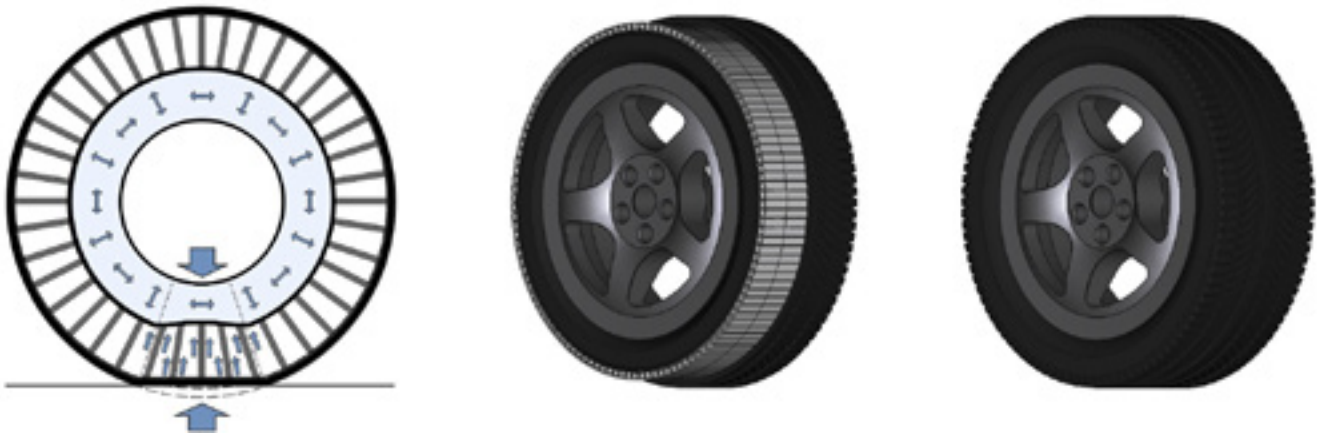
Fig. 2. Rueda mixta de automóvil: diagrama, corte parcial y vista externa. (Fuente: Advantaria / MixTire).
