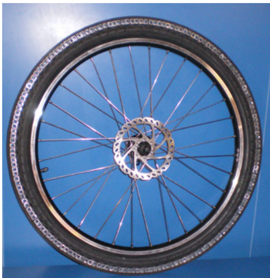
Fig. 1. Rueda mixta de bicicleta antes de acoplar la banda de rodadura (Fuente: Advantaria / Mixtire).
