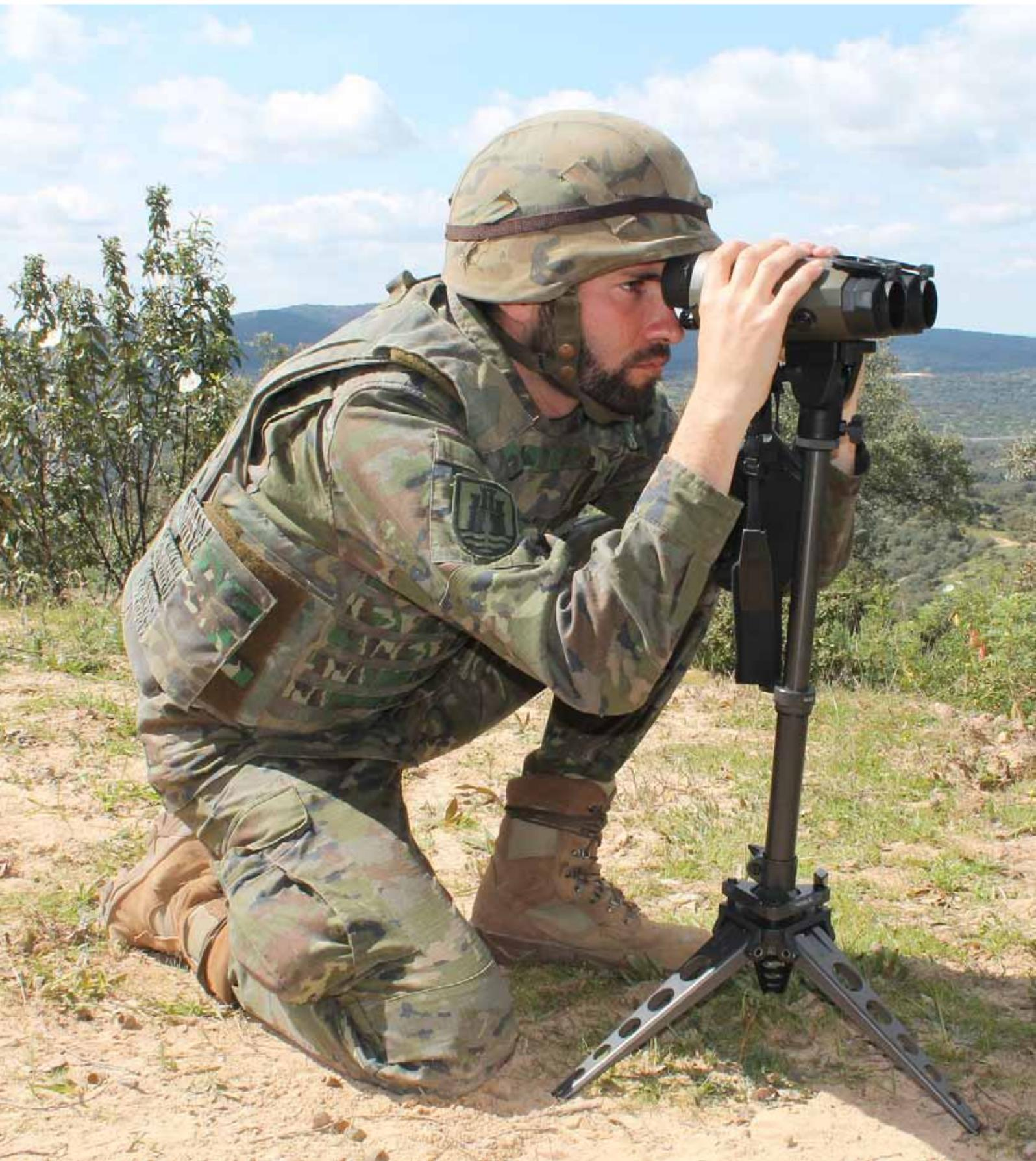
*El telémetro láser Vector 21 Nite es el principal instrumento de los observadores y "sensores"*
