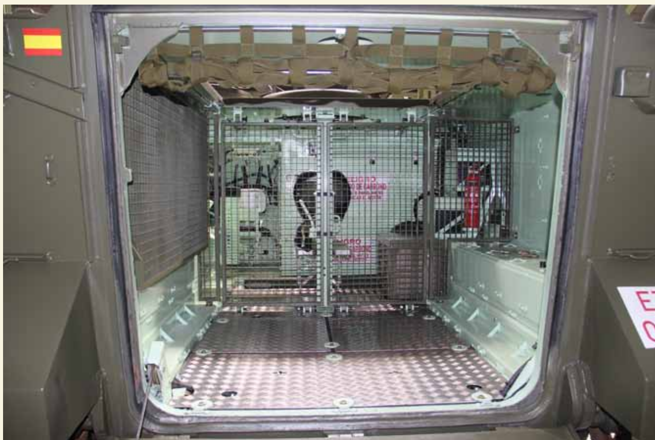
En la configuración de dos tripulantes, el TOA admite hasta 3.500 litros de volumen de carga
