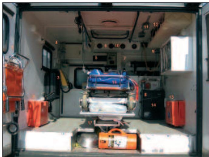
Figura 10: 1.- Silla de ruedas, 2.- Maletín de traumatología y curas, 3.- Monitor Desfibrilador Innomed Cardio Aid 200®, 4.- Toma de oxígeno, 5.- Control eléctrico, 6.- Salida de Aire Acondicionado, 7.- Botellas de oxígeno, 8.- Bomba de aspiración de secreciones, 9.- Respirador Hersill Vital ResQ®, 10.- Interruptor de luces, 11.- Soporte de Fluidoterapia, 12.- Bandeja de material vario, 13.- Maletín de soporte respiratorio, 14.- Nevera, 15.- Colchón de vacío. 16.- Carro móvil de camilla, 17.- Soporte abatible de camilla.
