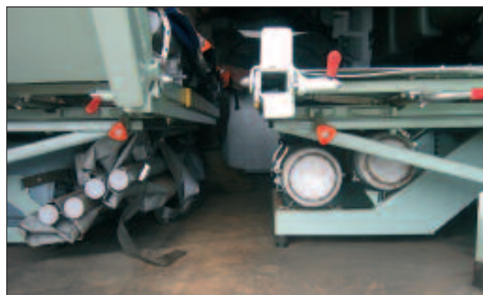
Figura 6: Detalle de la localización de las botellas de oxígeno y de dos de las 3 camillas de las que dispone por dotación el vehículo.
