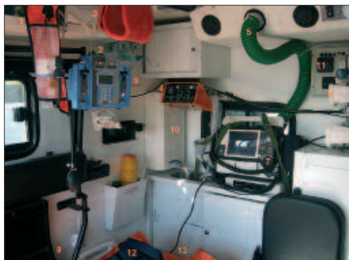
Figura 9: 1.- Dispositivo de fluidoterapia a presión, 2.- Bomba de perfusión IVAC ALARIS®, 3.- Dispositivo de inmovilización cervical, 4.- Ventilador Mecánico Dragger Oxilog 2000®, 5.- Manguera de transporte de aire acondicionado hacia la cabina de conducción (material de circunstancias), 6.- Botellas de oxígeno, 7.- Monitor Desfibrilador Life Pack 12®, 8.- Bomba de aspiración de secreciones, 9.- Tomas de oxígeno y humidificadores, 10.- Depósito de agua para lavado de manos, 11.- Cuadro eléctrico, 12.- Dispositivo de inmovilización tetracameral, 13.- Colchón de vacío.
