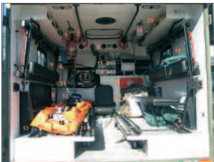
Figura 8: 1.- Dispositivo de fluidoterapia a presión, 2.- Bomba de perfusión IVAC ALARIS®, 3.- Dispositivo de inmovilización cervical, 4.- Ventilador mecánico Dragger Oxilog 2000®, 5.- Manguera de transporte de aire acondicionado hacia la cabina de conducción (material de circunstancias), 6.- Botellas de oxígeno, 7.- Monitor Desfibrilador Life Pack 12®, 8.- Bomba de aspiración de secreciones modelo V7M®, 9.- Tomas de oxígeno y humidificadores, 10.- Depósito de agua para lavado de manos, 11.- Cuadro eléctrico, 12.- Fijador tetracameral, 13.- Colchón de vacío. 14.- Camilla de «cuchara», 15.- Tela antidesgarro para transporte de bajas, 16.- Camilla normalizada OTAN tipo «Pole», 17.- Mochila de Soporte Vital Básico y Mochila de Soporte Vital Avanzado, 18.- Material de inmovilización: juego de collarines, chaleco espinal, férula de tracción de miembro inferior de Thomas, férulas neumáticas, Pantalón Militar Antishock (MAST), 19.- Soporte de fijación para administración de fluidoterapia, 20.- Cajas de material transparente de administración de fármacos (aparato respiratorio, aparato circulatorio, aparato urinario, acceso venoso), 21.- Malletín con material traumatológico.
