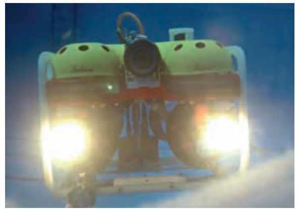
Un suboficial de la Sección de Apoyo Anfibio controla y dirige desde la superficie los movimientos en el agua de Falcon, un robot de reconocimiento, inspección y búsquedas subacuáticas.
