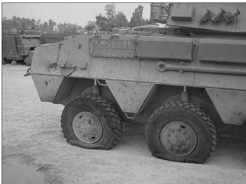
Estado en el que quedó el BMR después de la explosión.
