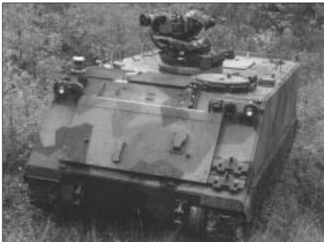
El "Bill" sueco fue el primer misil contracarro diseñado para atacar en picado.
