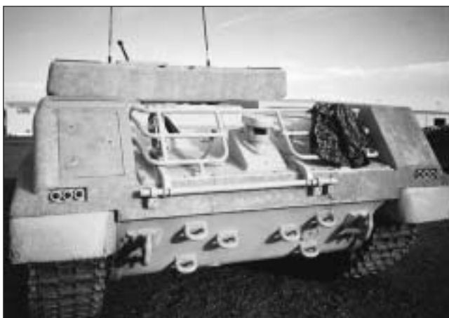
En la parte central de la popa se encuentra la cámara de TV protegida, que utiliza el conductor para los desplazamientos hacia atrás.
