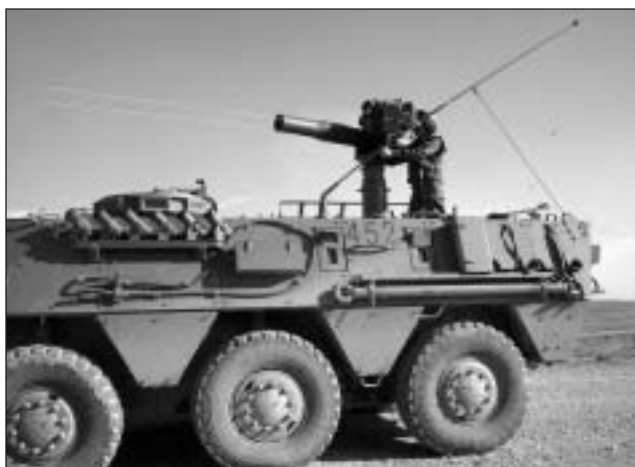
El sistema "TOW-LWL" monta una cámara térmica de segunda generación.
