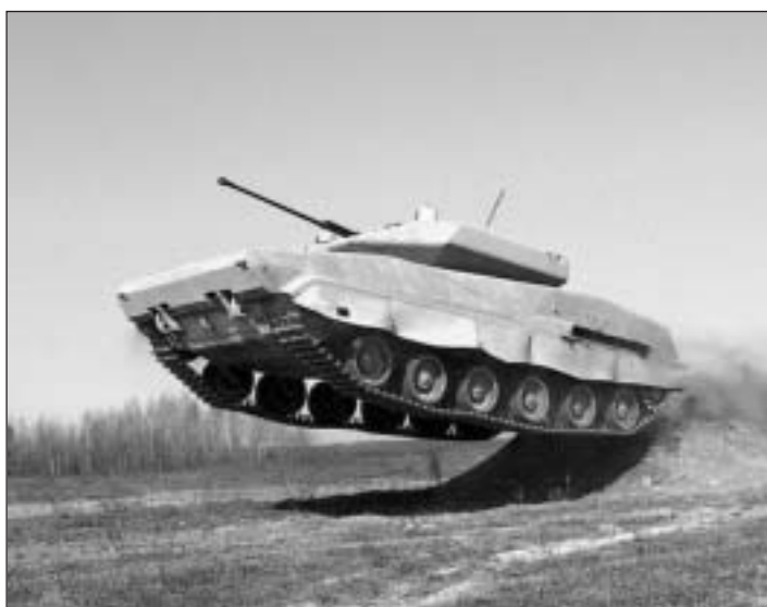
La suspensión oleoneumática le permite sortear obstáculos con gran facilidad.
