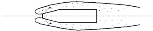
Fig. 9. Esquema de generación de cavidades artificiales por el método de Sedov.
