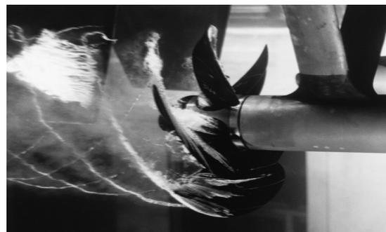
Fig. 2. Cavitación en las hélices de propulsión
