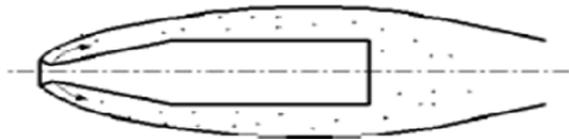
Fig. 10. Esquema de generación de cavidades artificiales con cavitador anguloso.
