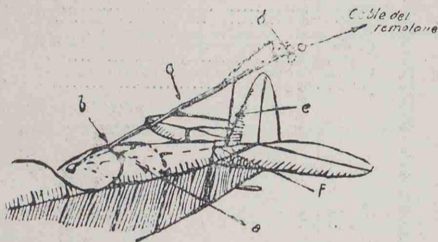
Fig. I. Dispositivo de anclaje para remolque, sobre una avioneta.
