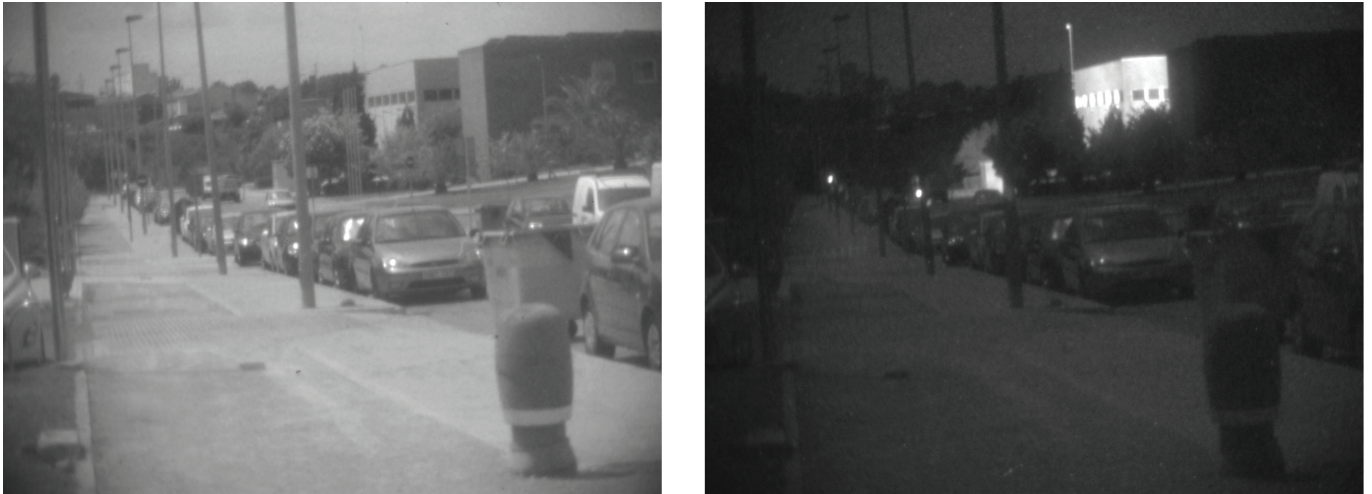
Fig. 3. En la parte de la izquierda arriba se encuentra una foto de la escena a captar y a continuación una secuencia de imágenes LIDAR a diferentes distancias. La profundidad de captura aplicada es de 36 m. (Fuente: AIDO)
