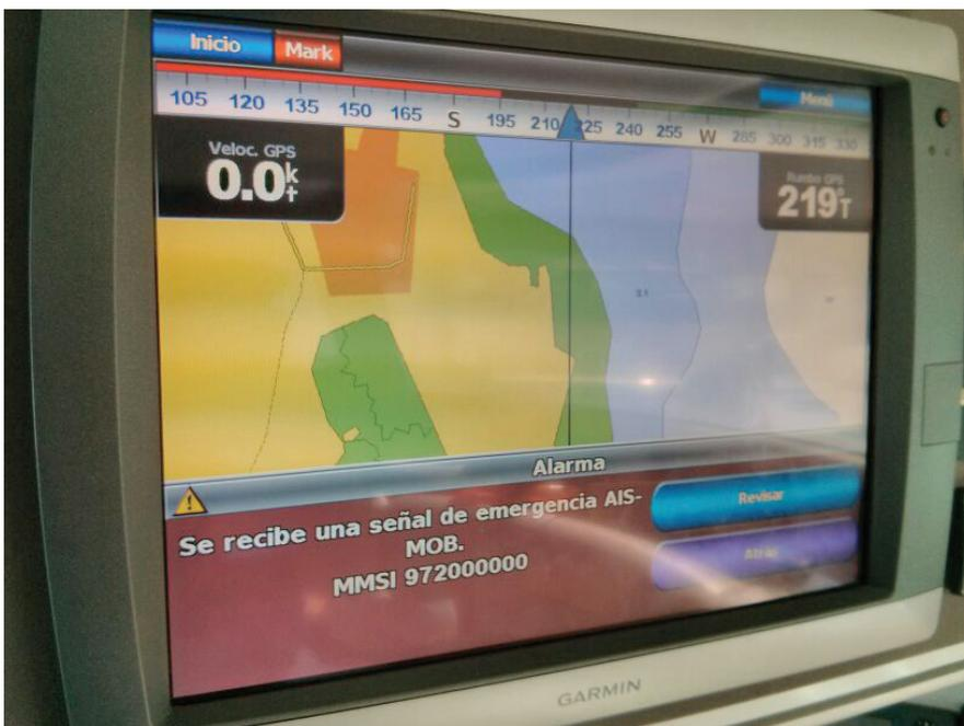
Fig. 5. Señal de emergencia AIS-MOB. (Fuente: Aeromarine S.L.).
