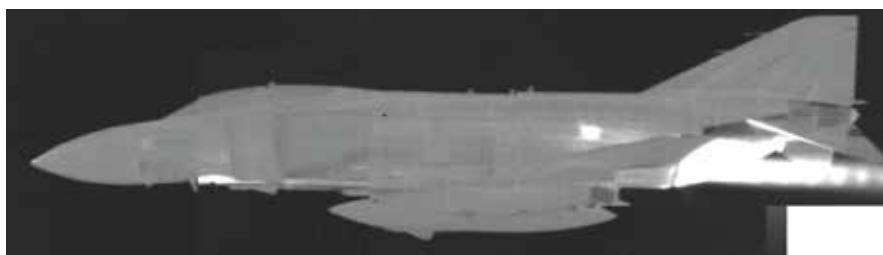
Fig. 2. Imagen espectral de un F-4 Phantom. (Fuente: White, J. Aircraft Infrared Principles, Signatures, Threats and Countermeasures. NAVAIR).
