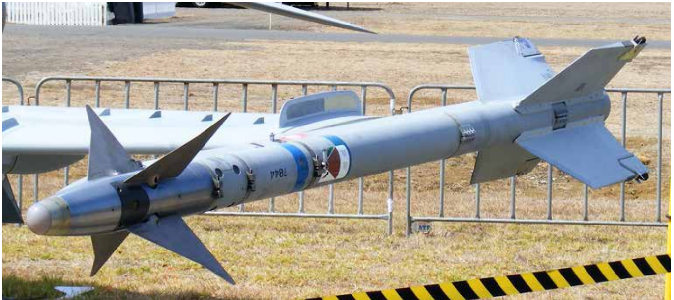
Fig. 1. AIM-9L/M con capacidad all aspect engagement con un detector de InSb. Ejemplo de la RAAF. (Fuente: 2009 Dr Carlo Kopp).
