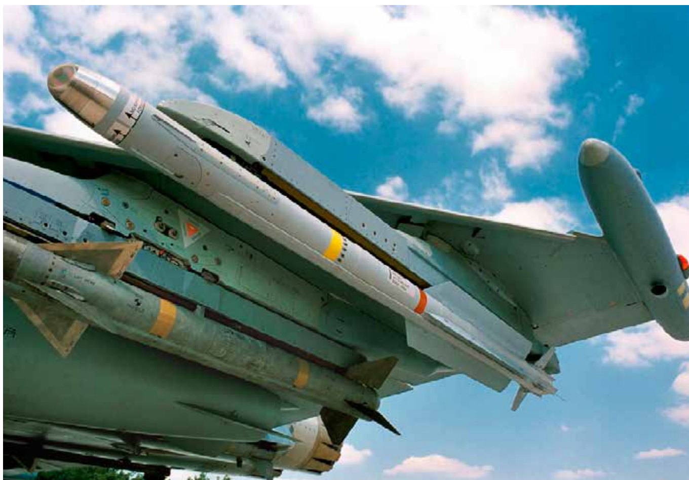
Fig. 3. Arriba: sección de guiado del Iris-T. Buscador de IIR de 128 x 128 elementos con \pm 90^\circ de FOR (Field of Regard) en los ejes de cabeceo y balance. Abajo: Iris-T en la estación subalar externa del EF2000. Se destacan las bandas amarilla y marrón que indican, respectivamente, la presencia de explosivos y motores cohetes. (Fuentes: http://www.defensa.gob.es [texto] y http://www.diehl-bgt-defence.de [imagen]).
