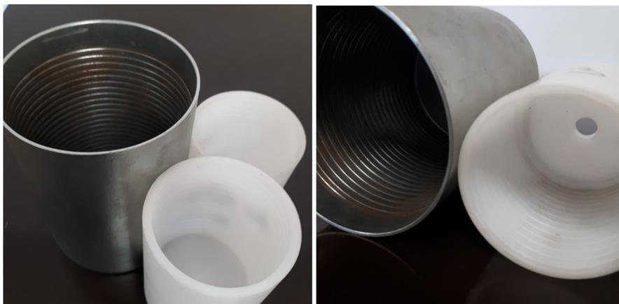
Fig. 5. Prototipo por impresión 3D y mecanizado del canister. (Fuente: propia).
