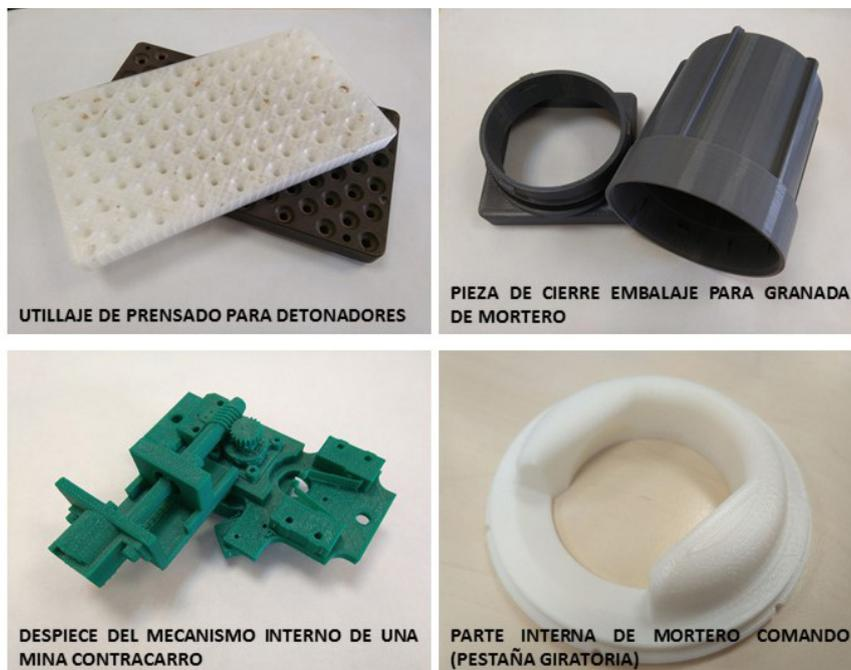
Fig. 1. Prototipos fabricados en diferentes materiales termoplásticos mediante impresión 3D. (Fuente: propia).
