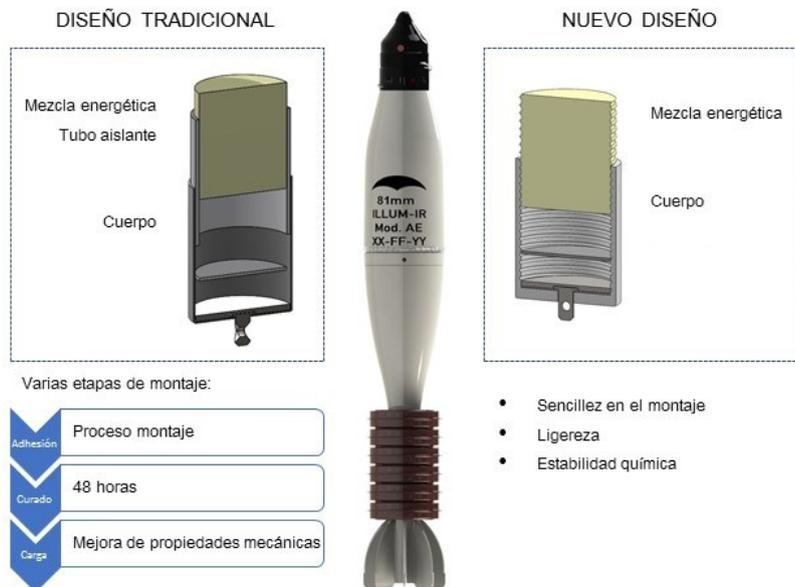
Fig. 4. Partes principales de la bengala y prototipo. (Fuente: propia).
