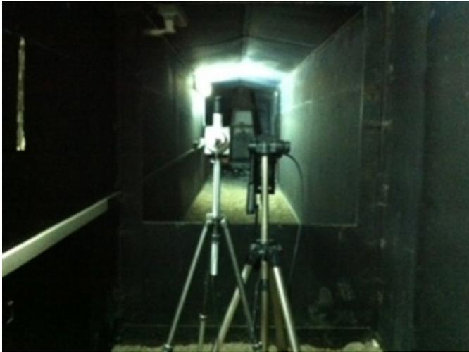
Fig. 7. Luxómetro y osciloscopio en túnel de quemado de bengalas. (Fuente: propia).
