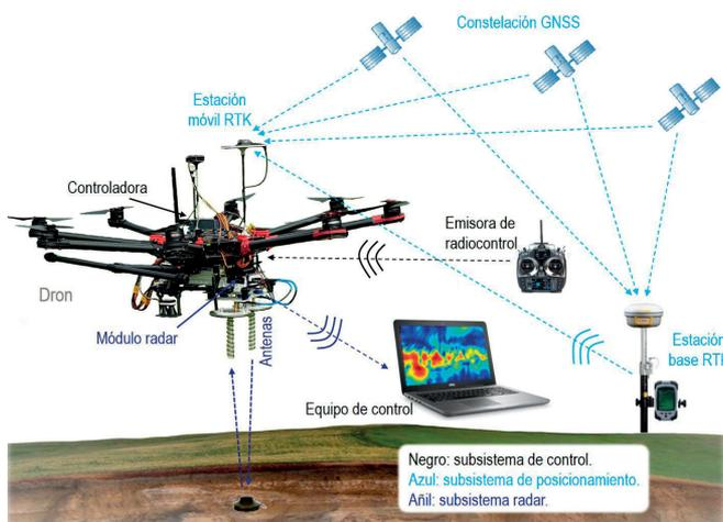
Fig. 2. Esquema de los subsistemas y componentes del prototipo implementado consistente en GPR embarcado en UAV. (Fuente: propia)
