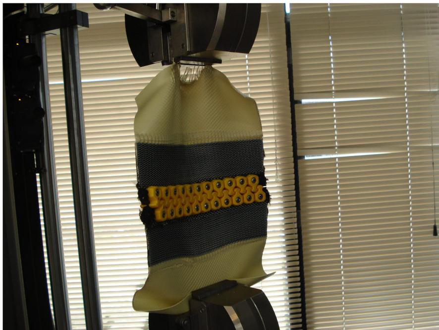
Fig. 3. Detalle de ensayos para probar la resistencia de la cremallera. (Fuente: AIMPLAS).
