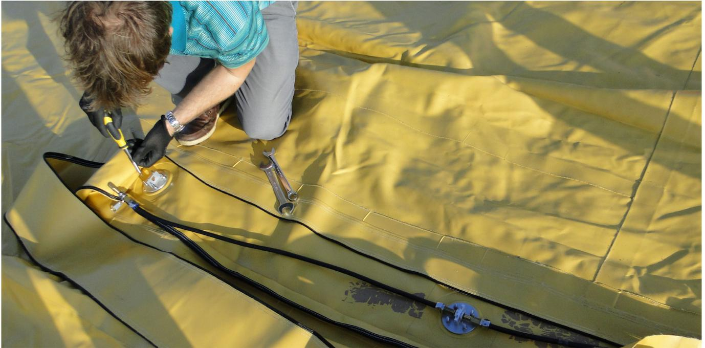
Fig. 4. Sistema de sensores de tensión instalados en el prototipo de REFRESH. (Fuente: AIMPLAS).
