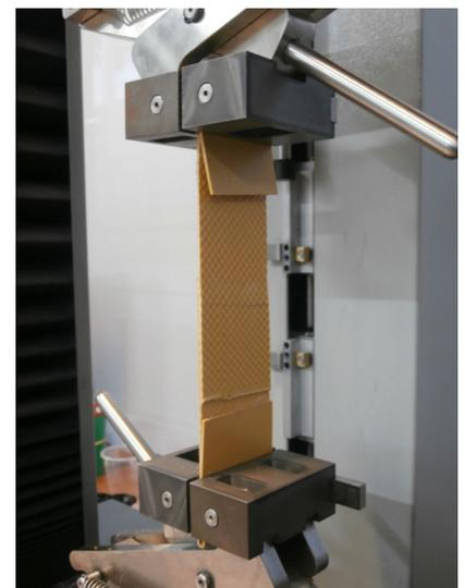
Fig. 2. Detalle de ensayos para probar la resistencia de las soldaduras. (Fuente: AIMPLAS).
