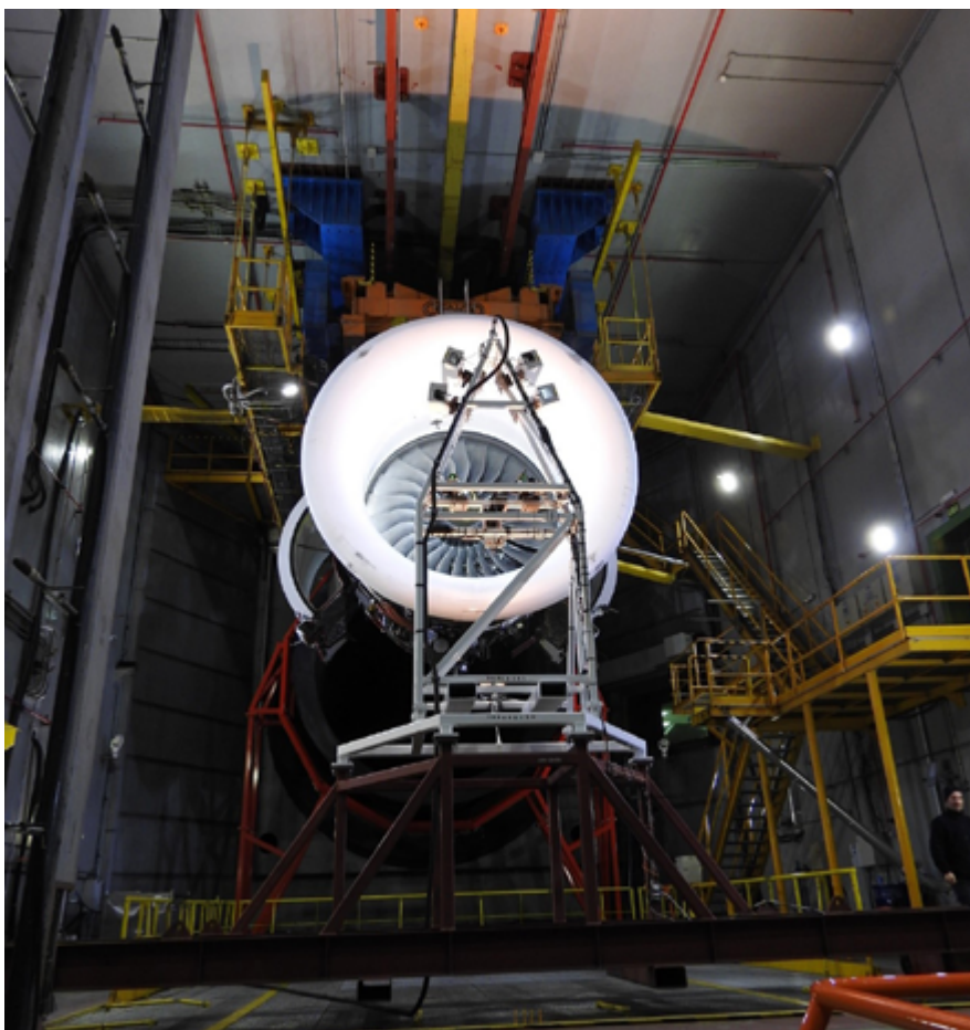
Motor con SPE (Special Test Equipment) instalado en la celda de ensayos. (Fuente: INTA)
