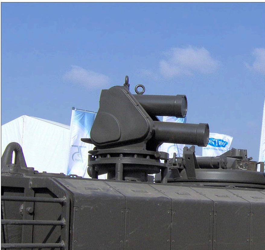
Figura 3. Sistema de protección activa Iron Fist
