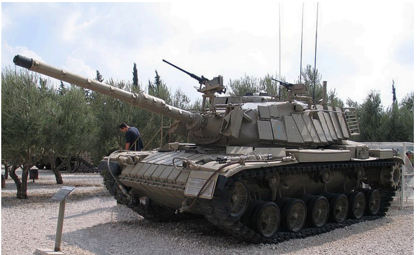
Figura 1. Tanque norteamericano con blindaje ERA
