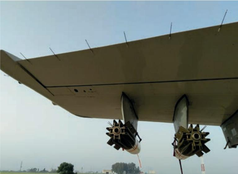
P-3 Orión armado con el modelo inerte (sin carga explosiva) de la mina MK-36 DST. (Imagen: flickr del EA)
