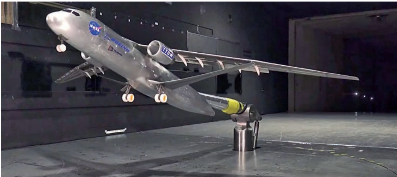
Maqueta del TTBW en el túnel aerodinámico de 14x22 ft del Langley Research Center usada para evaluar el comportamiento en vuelo a bajas velocidades y el efecto suelo. El sistema de montaje permite variar de manera independiente su posición en altura y su ángulo de ataque
