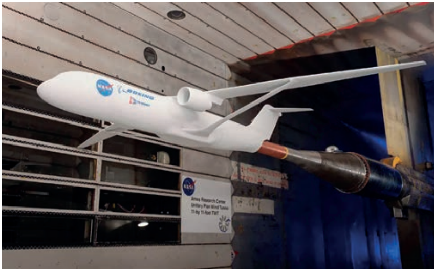
La maqueta del TTBW a escala 4,5% en el túnel aerodinámico de 11x11 ft del Ames Research Center, ensayada hasta mach 0,745 durante la tercera fase del SUGAR (4 de febrero de 2016)
