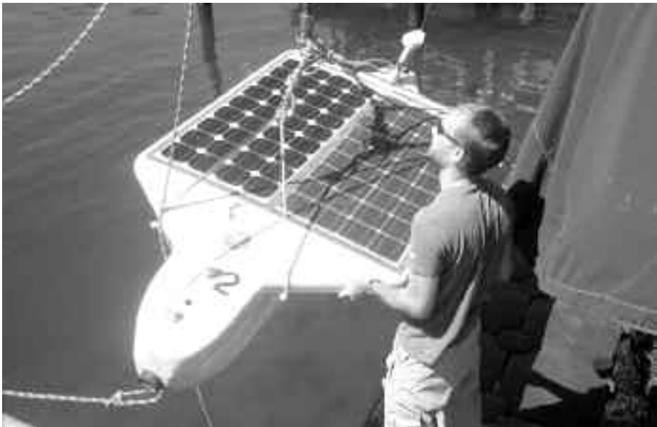
Tavros . Un investigador de la Universidad de Florida del Sur despliega un UUV Tavros 02 de alimentación solar.
