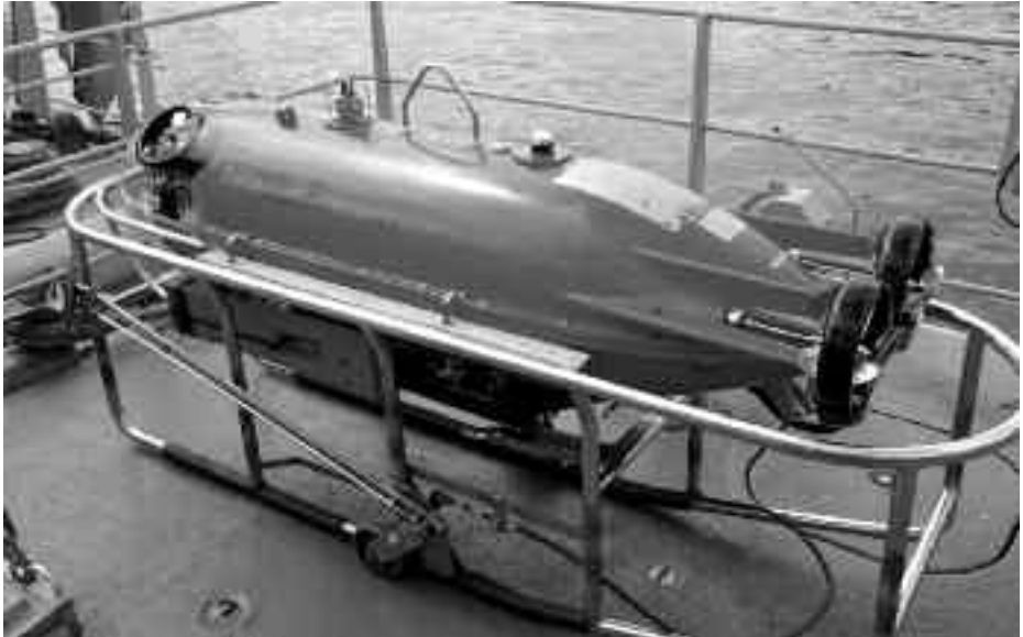
Pluto Plus. UUV es un ROV diseñado para llevar a cabo operaciones de medidas contra minas, de identificación y destrucción.
