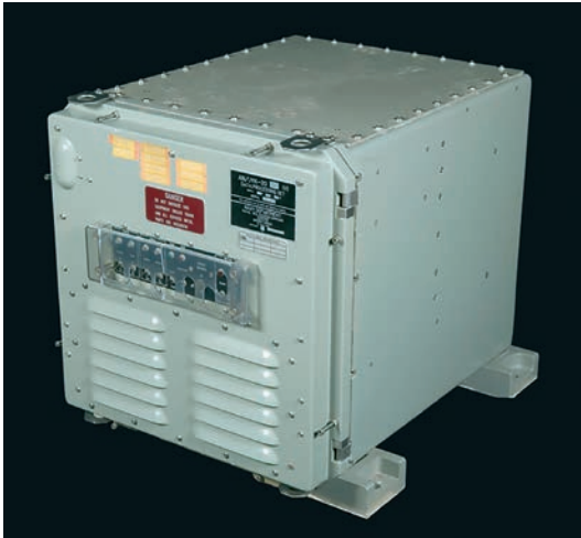
AN/UYK-20, el ordenador central del sistema TRITAN. (Fuente: www.awm.gov.au )
