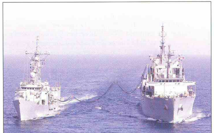
Figura 1. RAS ( Replenishment at sea ) del BAC Patiño realizando aprovisionamiento diurno en la mar a fragata aliada por su costado de estribor.
