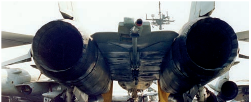
Sección posterior del F-14A mostrando las toberas del TF-30. (Imagen: Chiefhuggycbear)
