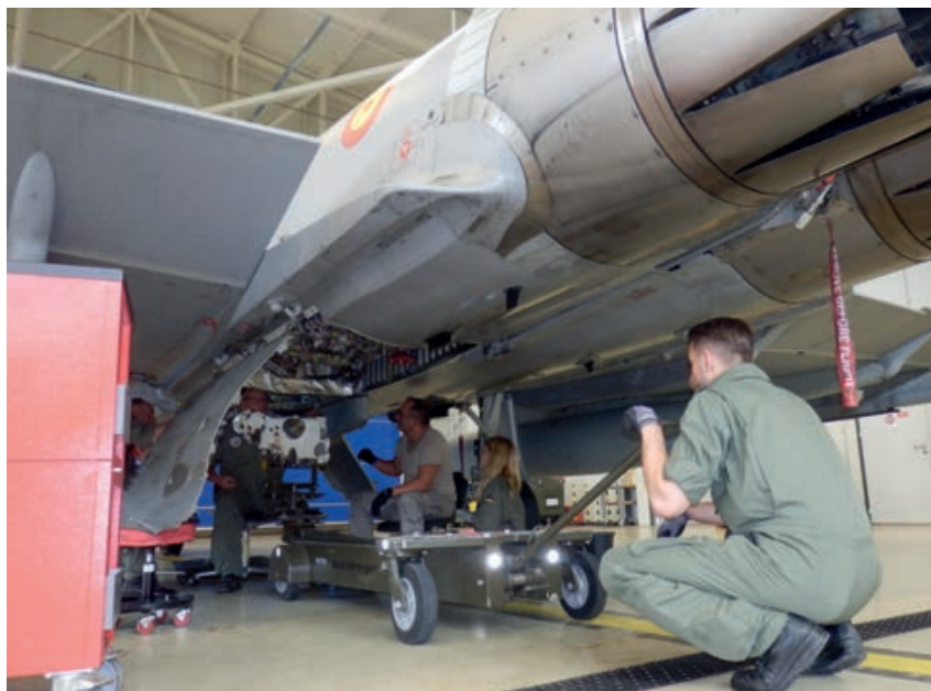
Equipo de mantenimiento combinado extrayendo la caja de accesorios del avión. (Imagen: destacamento Ámbar)
