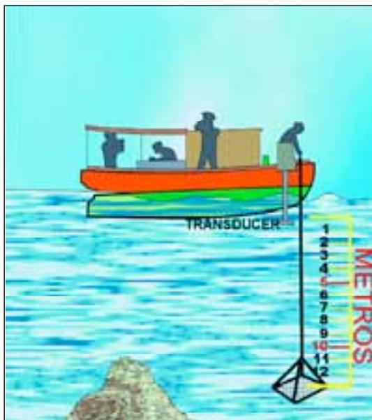
Método de calibración de la barra.
