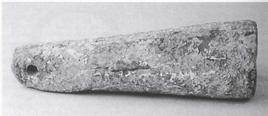
Escandallo de San Diego. Base 7 cm de diámetro, altura 24 cm. Plomo. Siglo XVII (7).
