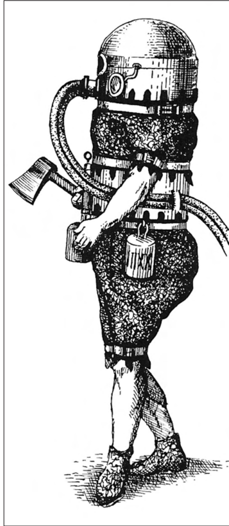
Imagen núm. 2. Aparato de buceo de M. Sánchez de la Campa. (Tomado de Ivars et al.).
