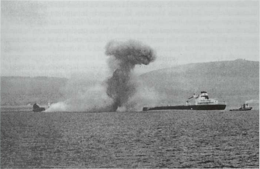
Fotografía tomada segundos después de la primera explosión. Puede observarse que, aunque la deflagración se ha extendido al castillo de proa, el hongo inicial parece proceder de un posible punto de flexión en la zona del 2C. (Foto: Blanco).
