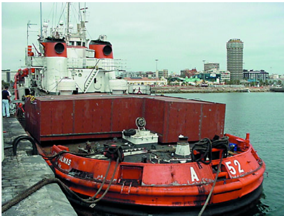
Aspecto de la toldilla con el nuevo casetón de habitabilidad ya instalado.
