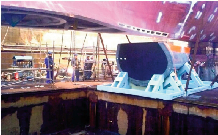
Desmontaje del domo de una F-100 para comprobación de corrosión.
