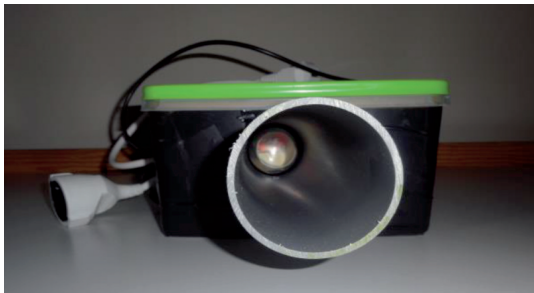
Imagen frontal de uno de los prototipos (a través del tubo tras la lupa se aprecia el fototransistor).
