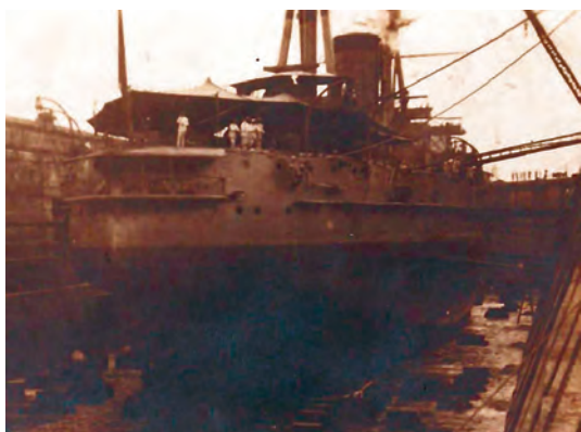
Fotografía del España en dique en Balboa para arreglar los desperfectos producidos en los canales patagónicos, donde el buque tocó en un bajo. (Foto: Santiago León & Co. Estudio, Panamá).
