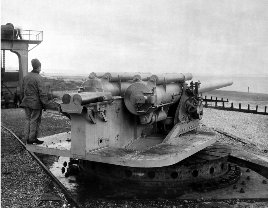
Piezas de 15 cm de tiro rápido, montadas originalmente en el crucero Reina Regente . (Foto: Archivo del Museo Naval. Madrid).
