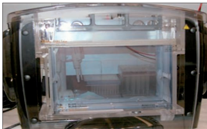
Figura 2. Dispositivo de electroforesis bidimensional, segunda dimensión.
