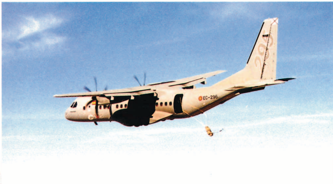
Recuperación de paracaidista enganchado por puerta izquierda (simulado por un muñeco lastrado).
