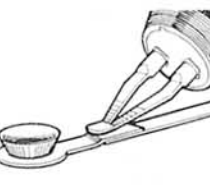
Reparación de circuitos, soldadura por refusión.
