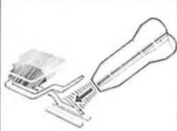
Retirada de "flat pack" por chorro de aire caliente.
