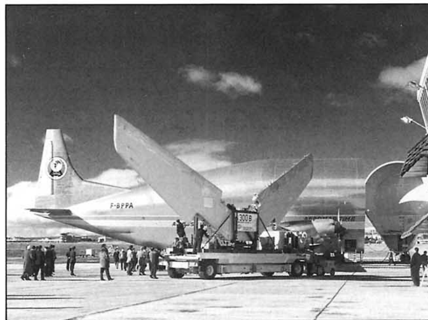
El Super Guppy carga un estabilizador horizontal del A 300 en Getafe.
