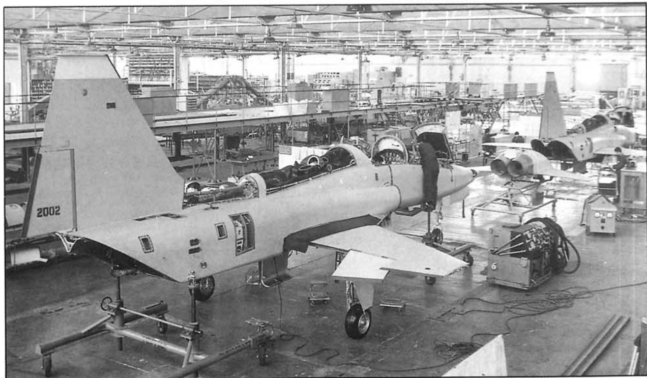
Línea de montaje final de Northrop F 5 en la factoría de Getafe de CASA. En primer plano el segundo F 5.
