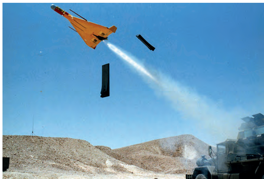
Lanzamiento de LM Harpy. (Imagen: https://www.iai.co.il/p/harpy )
