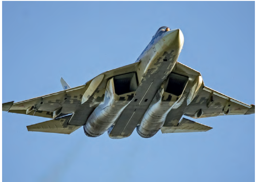
Panza del Su-57. Pueden observarse las compuertas de la bahía de armamento interno. (Imagen: VKS)
