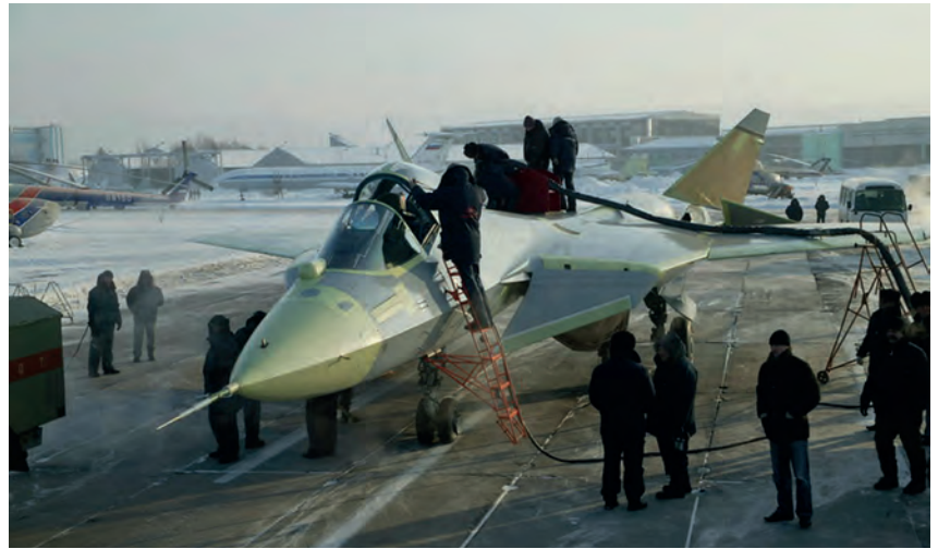
Imagen del T-50 (avión de ensayos 1). En esta imagen puede verse gran parte de las superficies aerodinámicas, como los timones de cola y la ausencia de estabilizador vertical, y los LEVCONs. (Imagen: Sukhoi)
