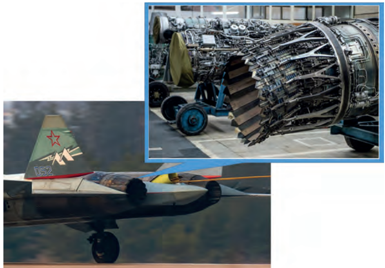
Su-57 en configuración mixta, ensayando el Izdeliye 30 integrado en la bahía izquierda contando como back-up con un AL-41F como motor derecho (imagen VKS). Detalle de las toberas de escape 3D del Izdeliye. (Imagen pública, Corporación Estatal Rostec)
